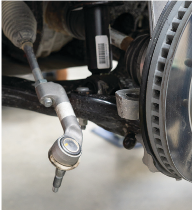
Fig. 2: Tie rod end link.
