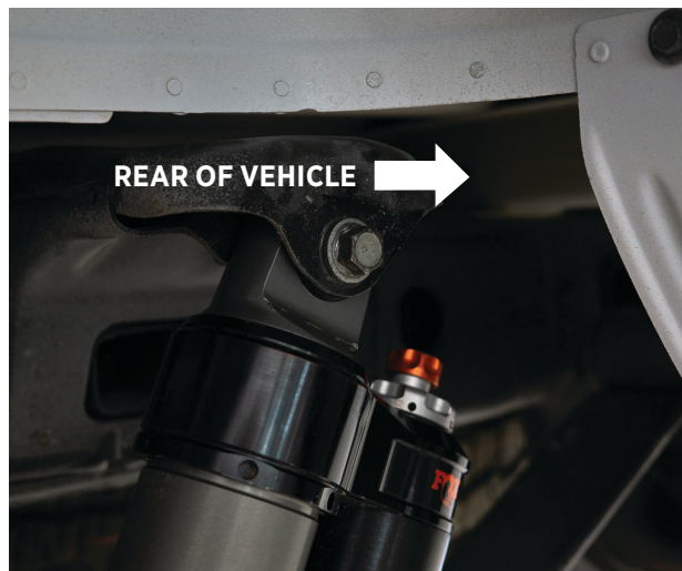
Fig. 20: Install the upper shock mount.
