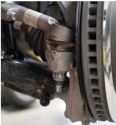
Fig. 15: Tie rod end link.
